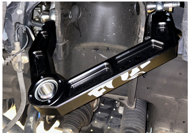
Fig. 15: Remove UCA Bolt.
